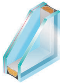
Sicherheitsglas VSG 6 mm Ug-Wert = 1,1 W/m²K
